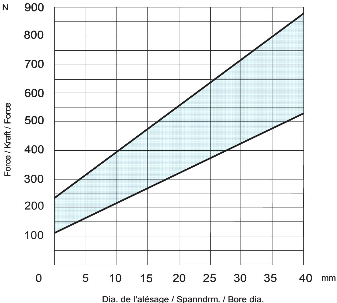
La force axiale de glissement dépend du diamètre de la barre à serrer
